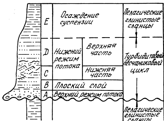
Рис. 25. Совершенный турбидитный цикл А. Боума и интерпретация осадков с позиций изменения режима потока (по Р. К. Селли, 1981):
