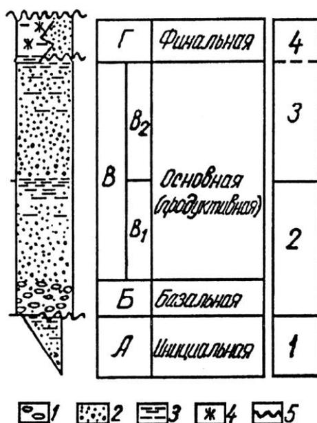
Рис. 6.4. Модель строения раннемезозойской угленосной формации (УФ): 1 - конгломераты и гравелиты; 2 - песчаники, 3 - алевриты и аргиллиты; 4 - пестроокрашенные породы; 5 - внутриформационные перерывы и несогласия. Справа: 1-4 - подформации
