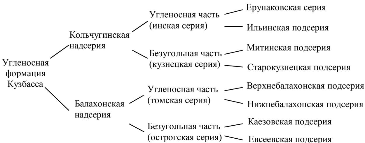
Рис. 2.14. Дистратония угленосных отложений Кузбасса на трех уровнях (более мелкие 4-6 уровни принципиально повторяют подобное двучленное строение) (<sup>49</sup>, с. 55)
