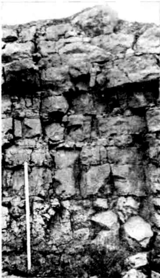
Рис. 4.15. Борт карьера для добычи горной породы с ярко выраженным блочным строением породы (слева) и схема строения горной породы, крупные блоки которой являются системами меньшего масштаба, как бы вложенными одна в другую<sup>132</sup>
